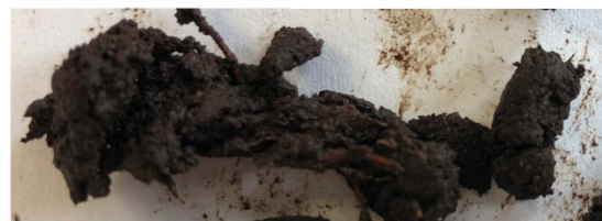
OA: Difficulté à former un boudin. Le boudin se rompt avant de pouvoir former un anneau (argiles <20%)
