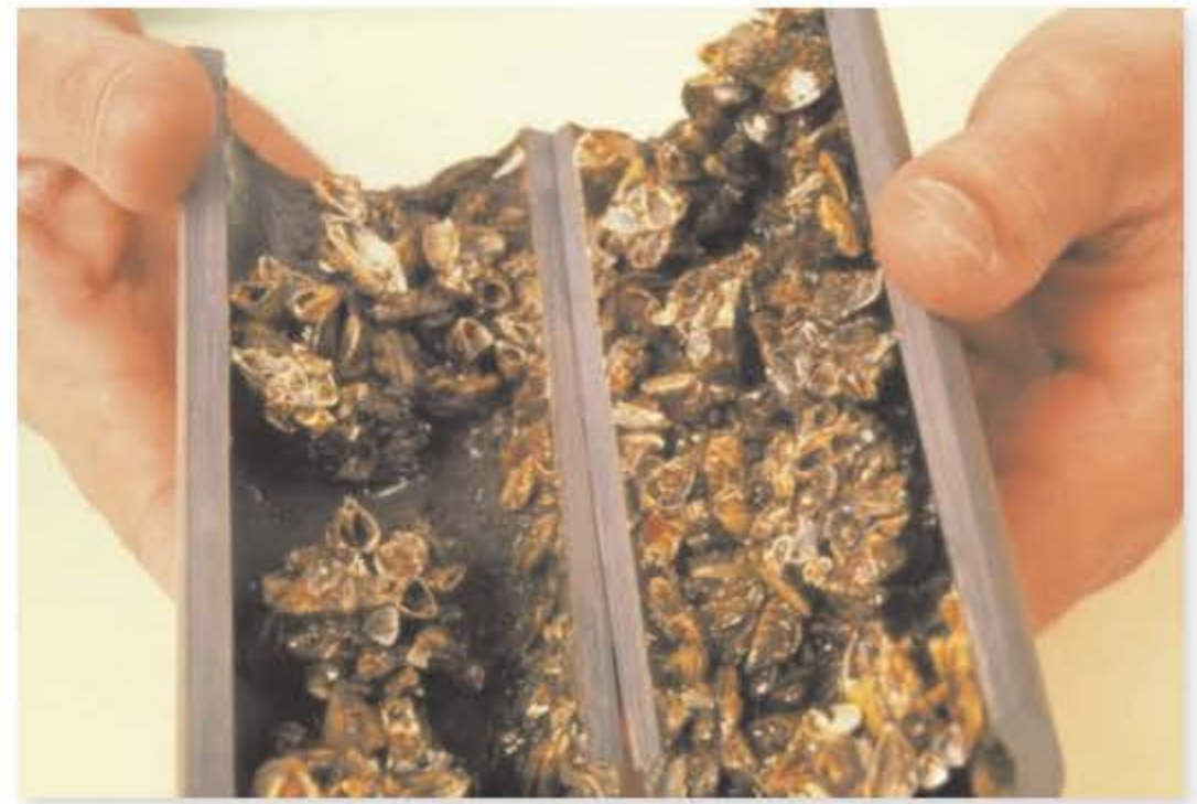
Figure 59.16 Moules zébrées ( Dreissena polymorpha ) bouchant un tuyau. Ces moules ont été introduites d'Europe et posent actuellement un problème grave dans les cours d'eau d'Amérique du Nord.
