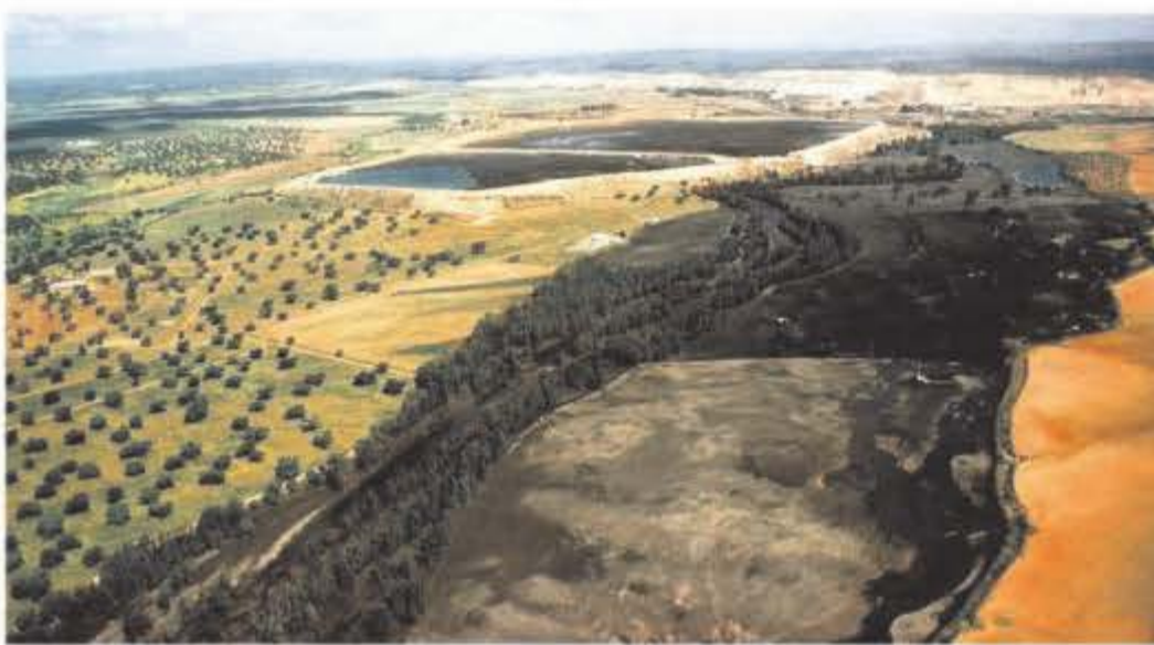
Figure 38.19 Le déversement de la mine d'Aznalcóllar. a. Quand le mur de rétention des déchets de la mine se rompit, 5 millions de mètres cubes de boues noires contenant des métaux lourds s'épandirent dans un parc national et dans la rivière Guadiamar. b. De grandes quantités de boue furent récupérées mécaniquement. c. La phytoremédiation paraît être une solution prometteuse pour la récupération des métaux lourds restants.
