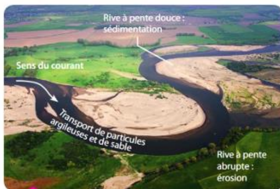
1 Dépôt et transport de sédiments en rivière.
