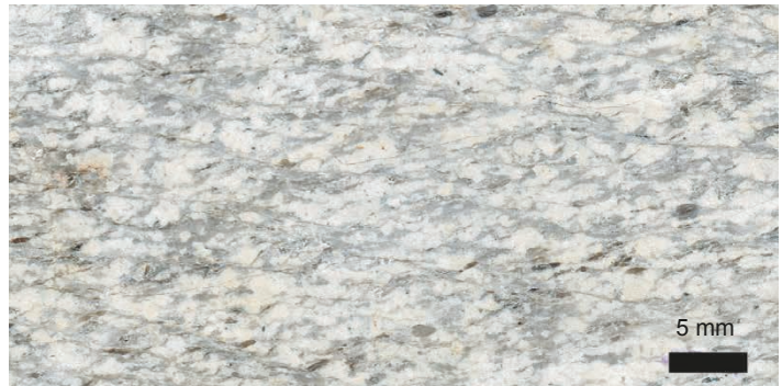
Figure TP19.5 Coupe effectuée perpendiculairement aux plans de foliation d'une roche métamorphique.
