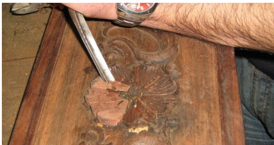
Esecuzione della scolpitura di una porzione mancante del rosone centrale a toppa di un cassetto di un mobile liberty.
