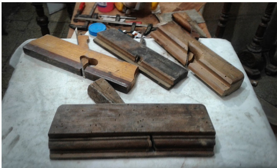
Pialle per sagomare il legno: la sponderuola, la pialla per le scanalature e quelle per le modanature.
