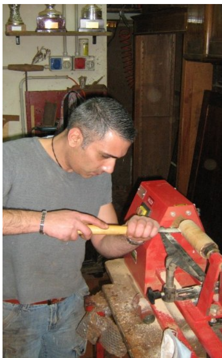
Creazione di una piccola colonna tornita
