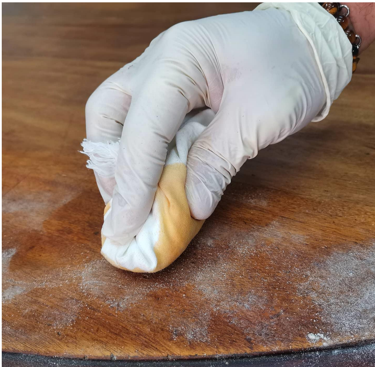
Fase di lucidatura a tampone riempimento del poro
