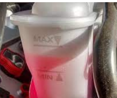
Deposito de líquido refrigerante
