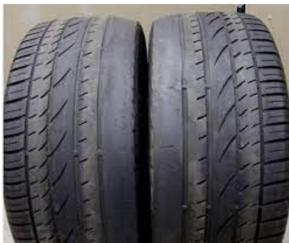
Neumáticos con excesivo desgaste.
