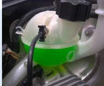
Deposito de líquido refrigerante
