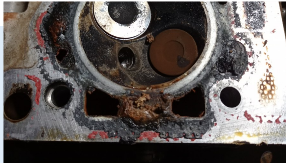
Junta tapa de cilindros quemada.
