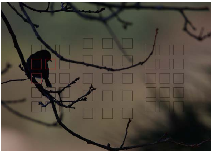
Capteurs AF d'un reflex avec activation sur le sujet visé.
