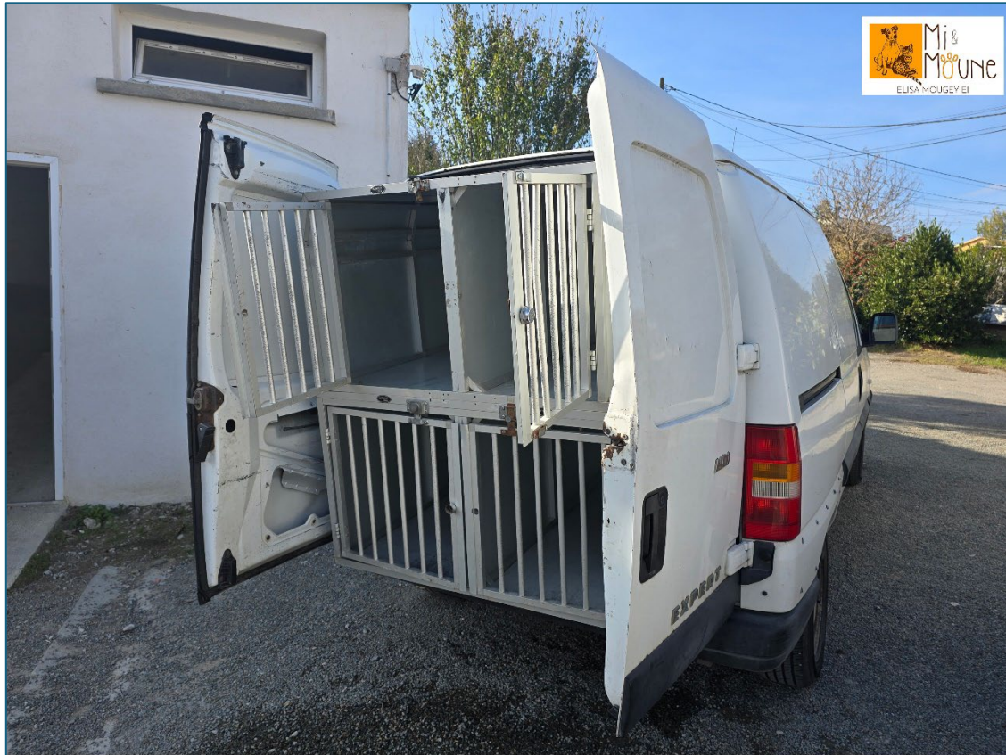
Véhicule de transport adapté pour caisses à chats et chiens de petit à moyen gabarit. Conteneurs entièrement démontables, désinfectables et désinfectés après chaque transport.
