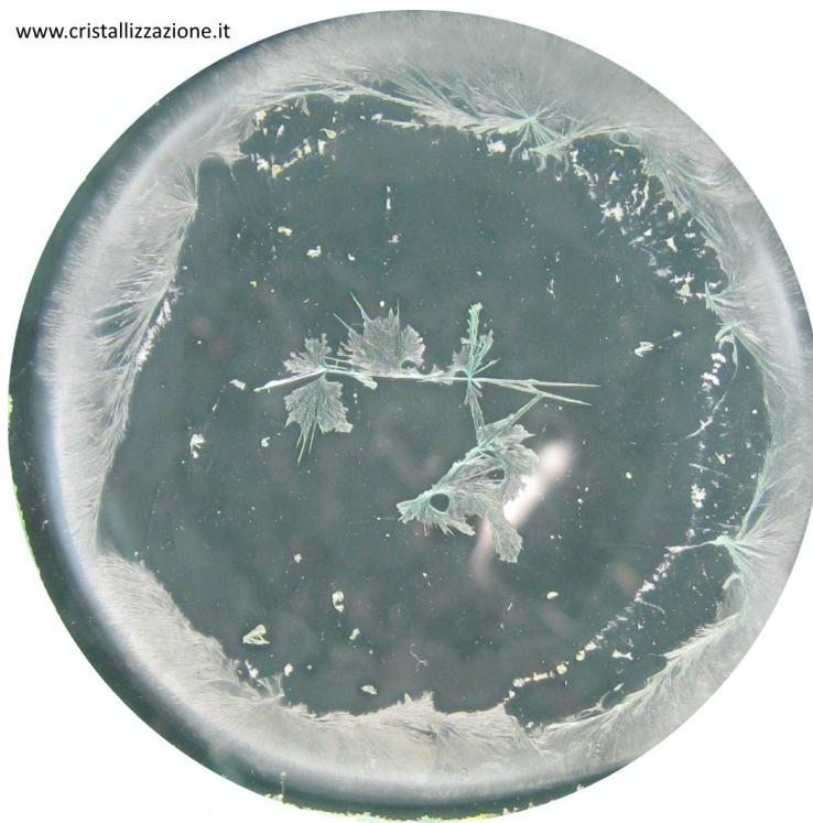
Acqua dell'acquedotto dopo trattamento con resine anioniche e trattamento UV
